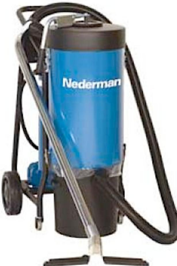
Σύστημα κενού σχεδιασμένο για γενικούς καθαρισμούς ,απορρόφηση σκόνης τροχισμάτων μεταφορά πούδρας κλπ. Δυνατότητα πρόσθετου φίλτρου microfilter .Διακόπτης αλλαγής φάσεων.
