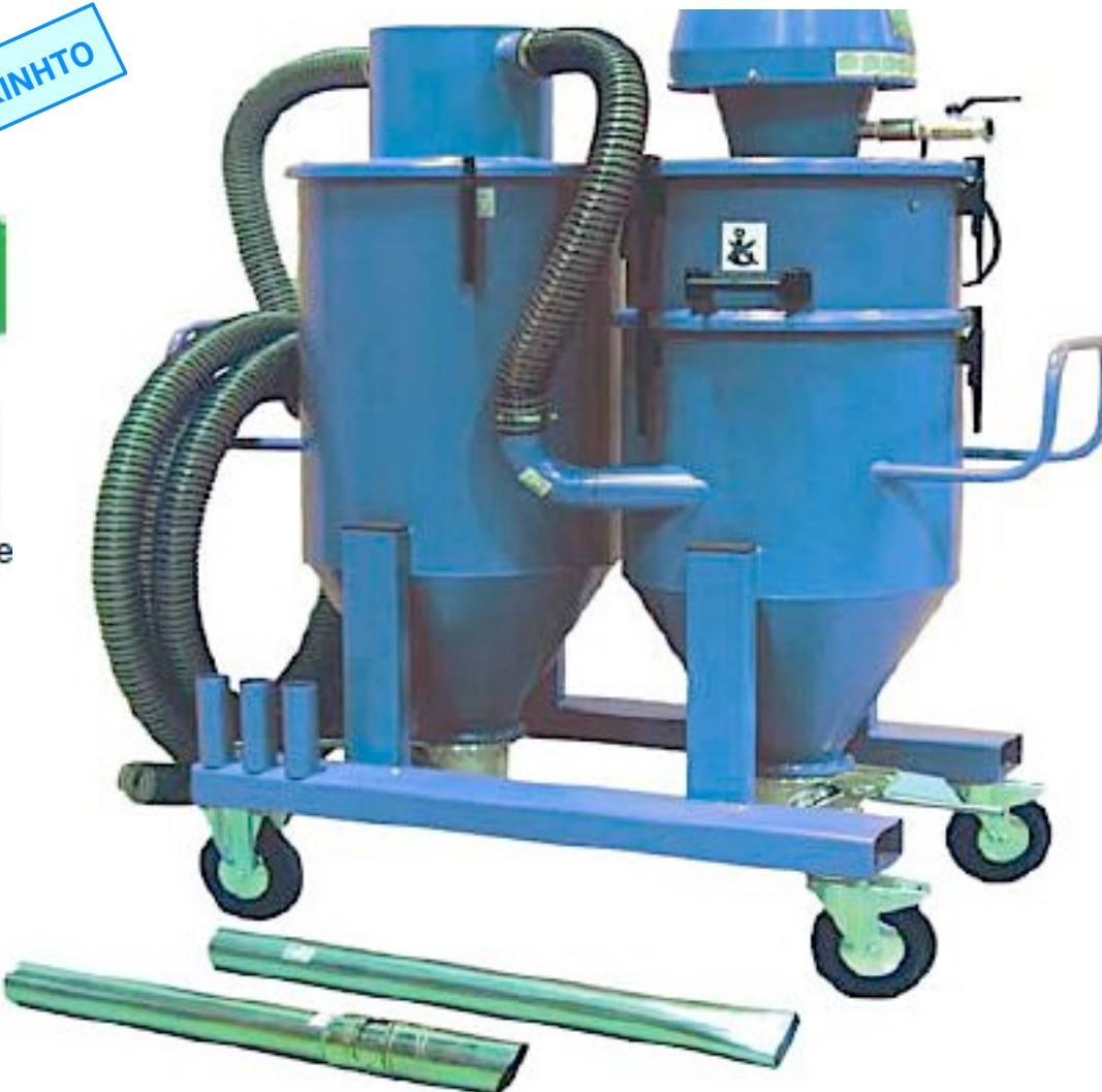
Ισχυρό και ευέλικτο μηχάνημα κενού σε φορείο με βαλβίδα εκκένωσης της σκόνης και των τεμαχιδίων στον κάδο του προδιαχωριστήρα. Τα καθαρισμένα τεμαχίδια αδειάζουν σε ένα κάδο ή σε ένα σιλό ή σε ένα σύστημα μεταφοράς. Η σκόνη κατακρατείται στο φίλτρο NCF και συλλέγεται στο σιλό της δεύτερης βαθμίδας. Κατάλληλο για εγκαταστάσεις αμμοβολής.
