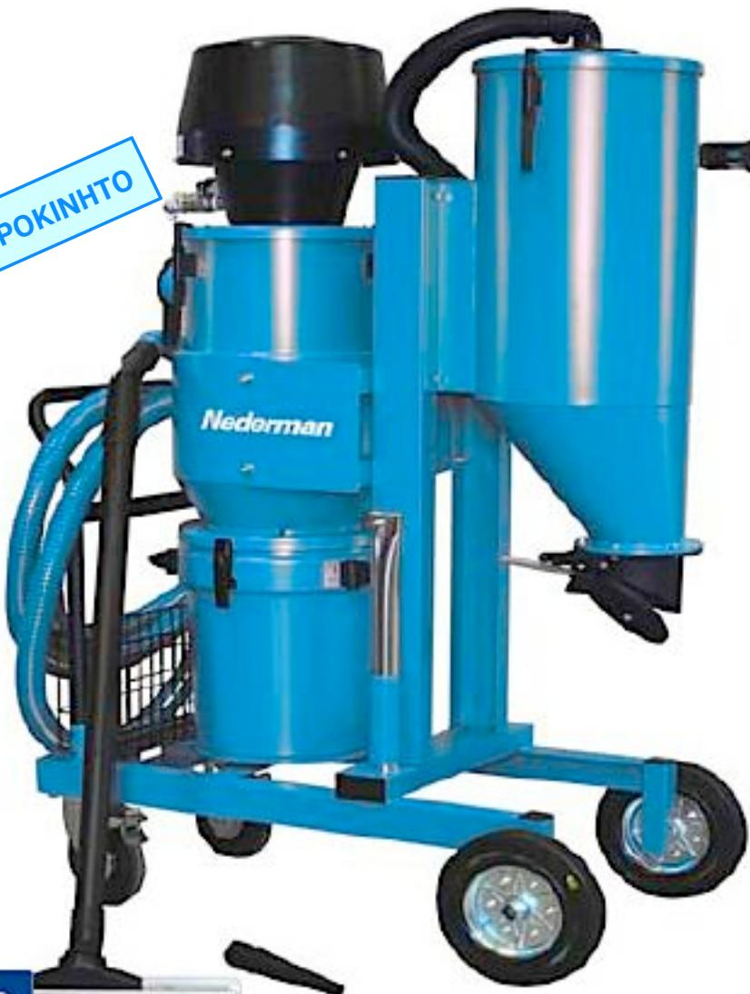
Σύστημα με δύο κάδους σχεδιασμένο για την απομάκρυνση των βιομηχανικών απορριμμάτων. Μεγάλοι περιστρεφόμενοι τροχοί με φρενο για την εύκολη διακίνηση. Ο σχεδιασμός του σιλό επιτρέπει την εκκένωση σε χοάνες ή σε ειδικά δοχεία. Δυνατότητα τοποθέτησης ρυθμιζόμενου αντιβάρου και ειδικού στηρίγματος για εκκένωση σε σάκους. Το φορείο έχει υποδοχές για χειρισμό με περονοφόρο
