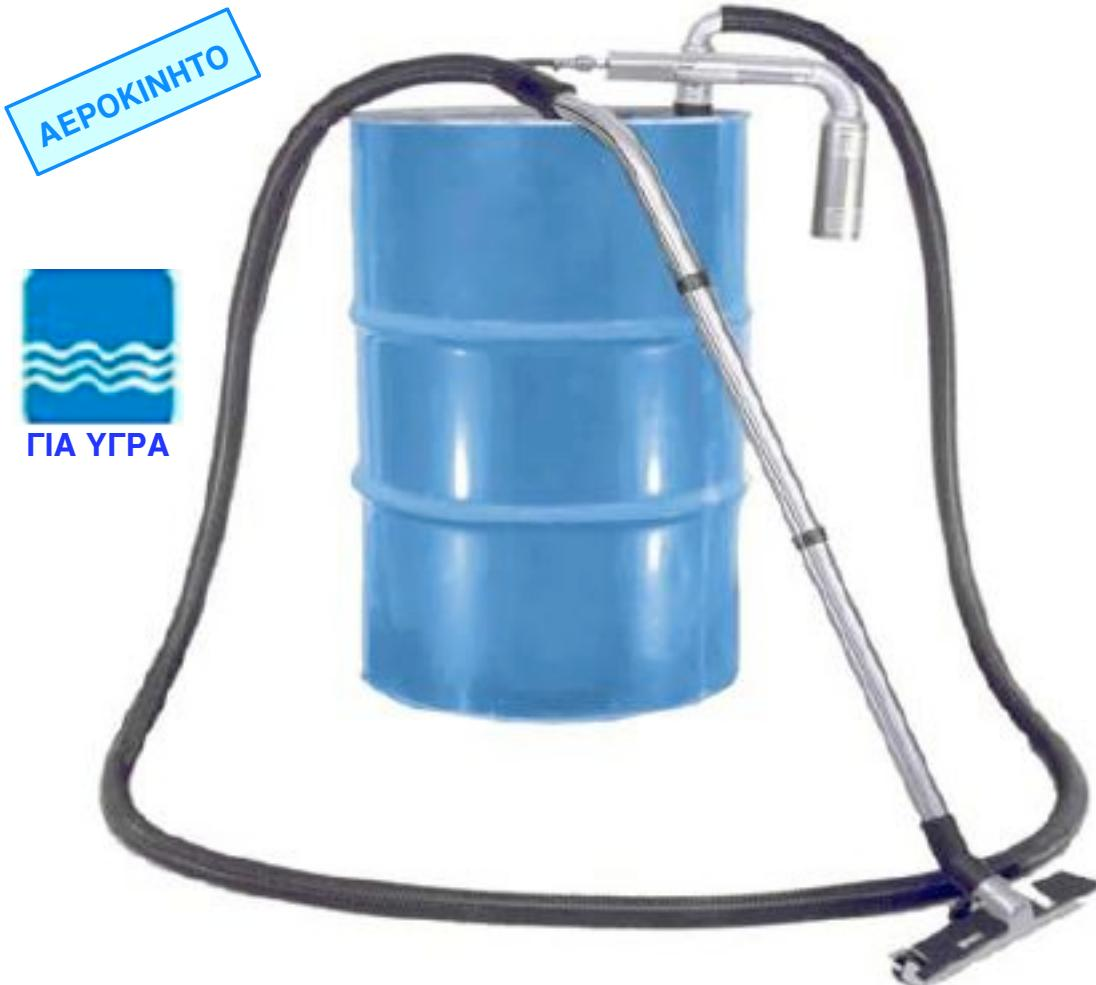
Απλό σύστημα για την εύκολη μετάγγιση σε βαρέλια λαδιού, χημικών ,νερού κλπ.Τοποθετείται στην οπή του βαρελιού (R=2") Με σύνδεση στον σωλήνα του πεπιεσμένου αέρα και στον σωλήνα απορρόφησης είναι έτοιμη για λειτουργία. Η απορρόφηση σταματά μόλις γεμίσει το βαρέλι με την ενέργεια ενός πλωτήρα που φέρει το σύστημα.
