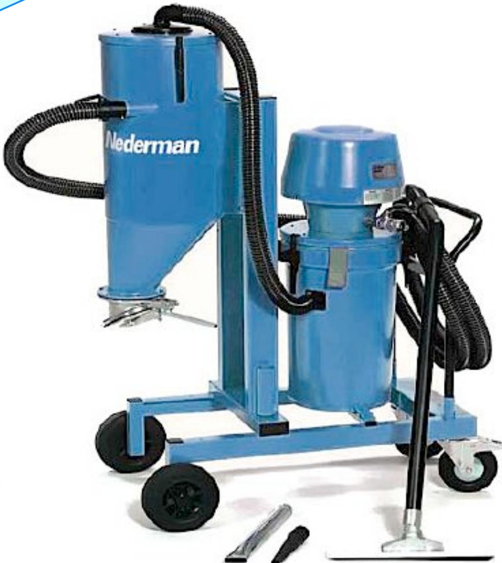
Σύστημα με δύο κάδους σχεδιασμένο για την απομάκρυνση των βιομηχανικών απορριμμάτων. Μεγάλοι περστρεφόμενοι τροχοί με φρενο για την εύκολη διακίνηση. Ο σχεδιασμός του σιλό επιτρέπει την εκκένωση σε χοάνες ή σε ειδικά δοχεία. Δυνατότητα τοποθέτησης ρυθμιζόμενου αντιβάρου και ειδικού στηρίγματος για εκκένωση σε σάκους. Το φορείο έχει υποδοχές για χειρισμό με περονοφόρο
