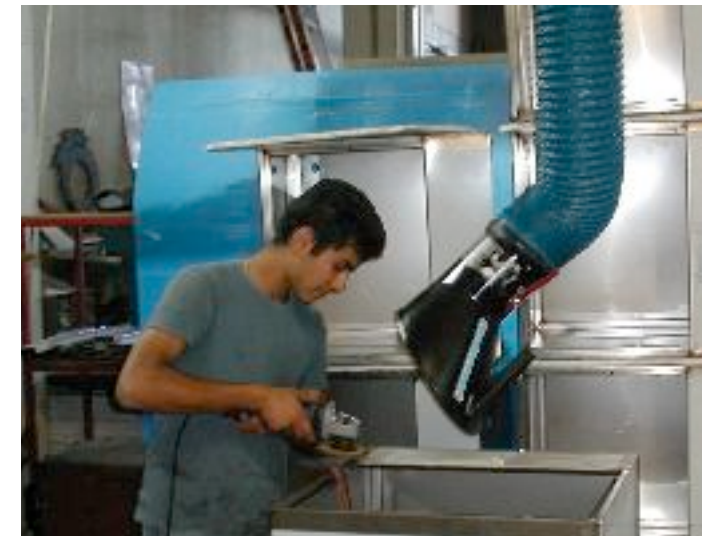
Τρόχισμα ανοξειδώτων -Εταιρεία ΕΛΒΙΟΜΕΞ. Χρήση βραχίονα απαγωγής
